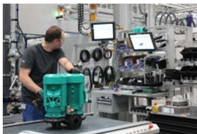
Die Software flexAssistant ersetzt die papiergebundene Anleitung und Dokumentation mit einer digitalen Montageführung: Der Bediener erhält über einen Monitor alle relevanten Informationen über das aktuelle Bauteil sowie die notwendigen Arbeitsschritte, die an diesem Montageplatz vorgenommen werden sollen.
