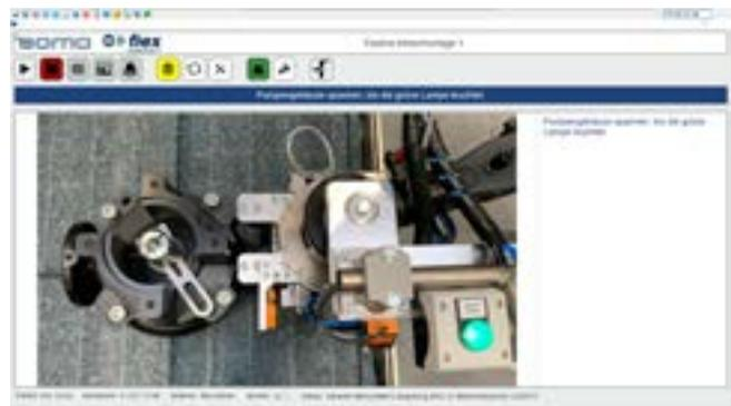
**Bildunterschrift:** Die Werkerführung unterstützt die Montage durch eine virtuelle Schritt-für-Schritt-Anleitung, in der beispielsweise das zu benutzende Werkzeug und die entsprechende Schraubenposition gezeigt werden.
