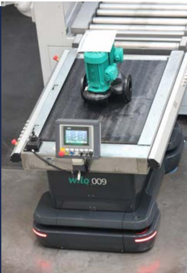
Dank intelligent vernetzter, fahrerloser Transportsysteme kann jede Montagestation frei angefahren werden, wobei selbst Überholvorgänge möglich sind. Das System verhindert dabei automatisch den Weitertransport etwa bei Nichterfüllung bestimmter Kriterien oder sorgt für eine Umleitung zur Analyse. Quelle: WILO SE
